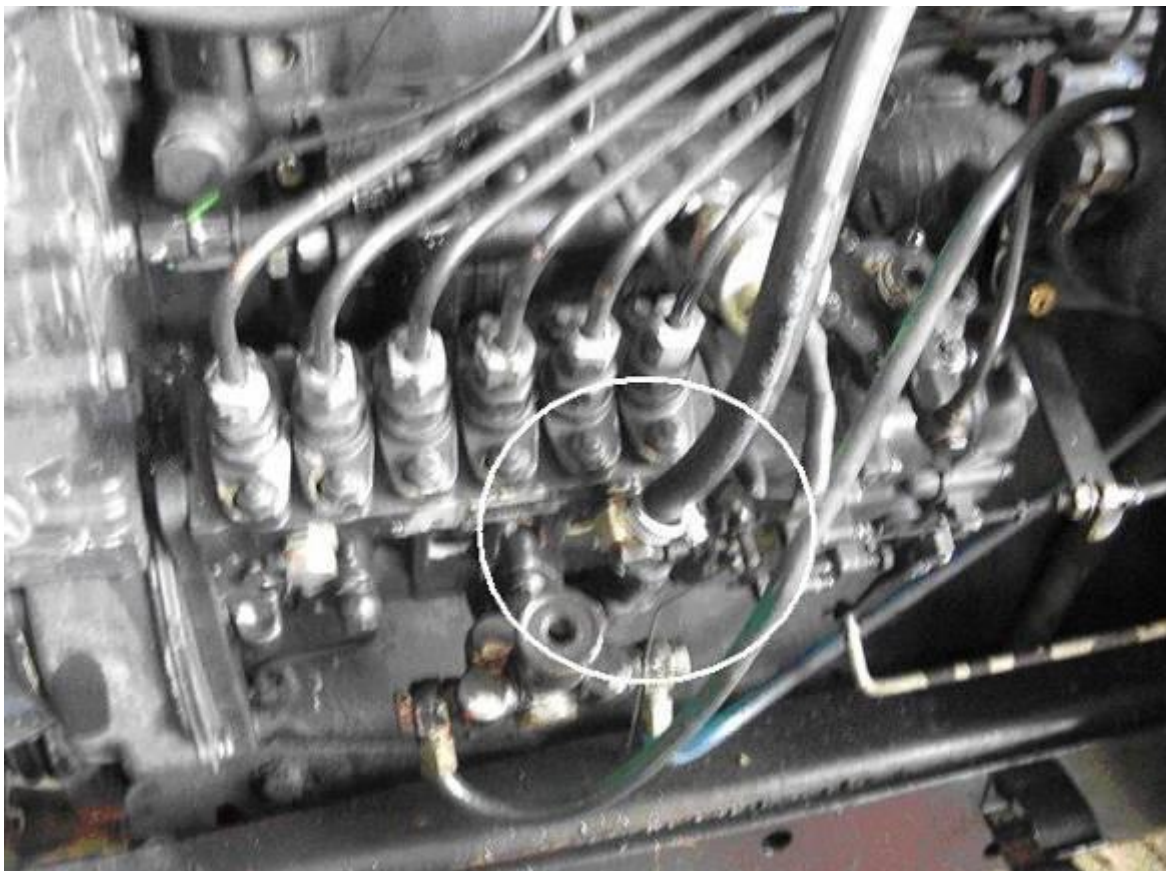
Рис. 10 Выход ДРТ соединяется со входом ТНВД
