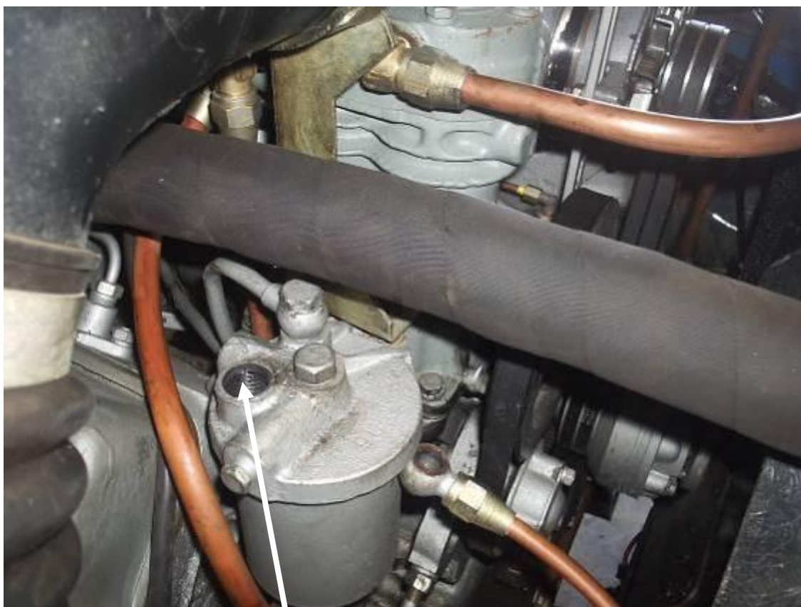
Рис.19 Ключом на "24" выкручивается из ТНВД штуцер с дросселем
