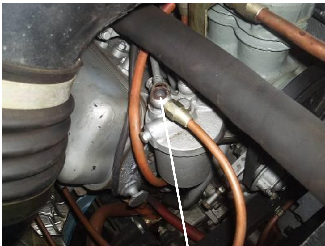
Рис. 17 Откручивается двойной штуцер с ФТО
