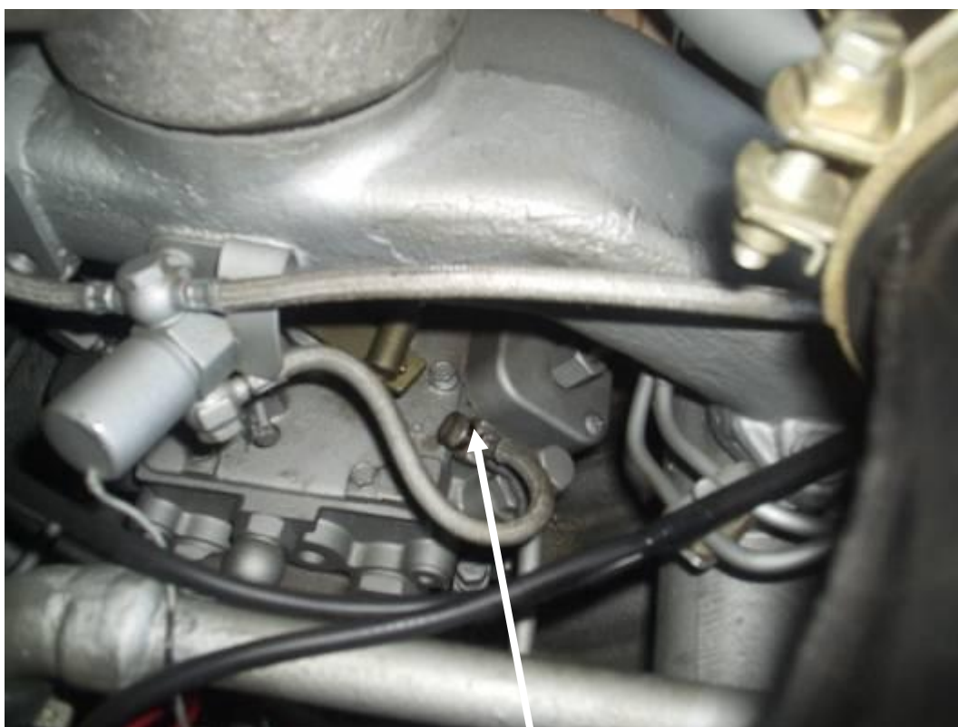
Рис. 18 Снимаются трубки, ведущие к ТНВД, выкручивается из трубки шланг, ведущий к подогревателю
