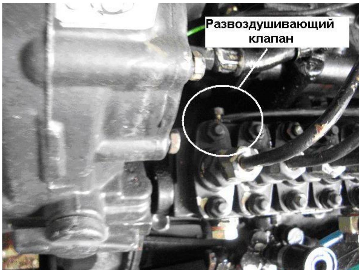
Рис. 14 Расположение развоздушивающего клапана на ТНВД Motorpal
