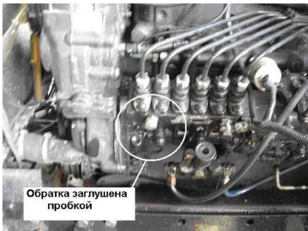
Рис. 7 Заглушение обратной магистрали в ТНВД
