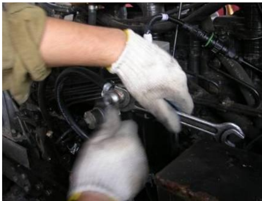
Рис. 11 Заворачивание штуцера на входе ДРТ
