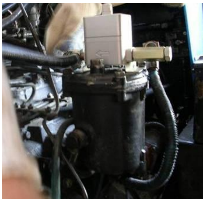
Рис. 9 Штуцер с обратным клапаном на выходе ДРТ
