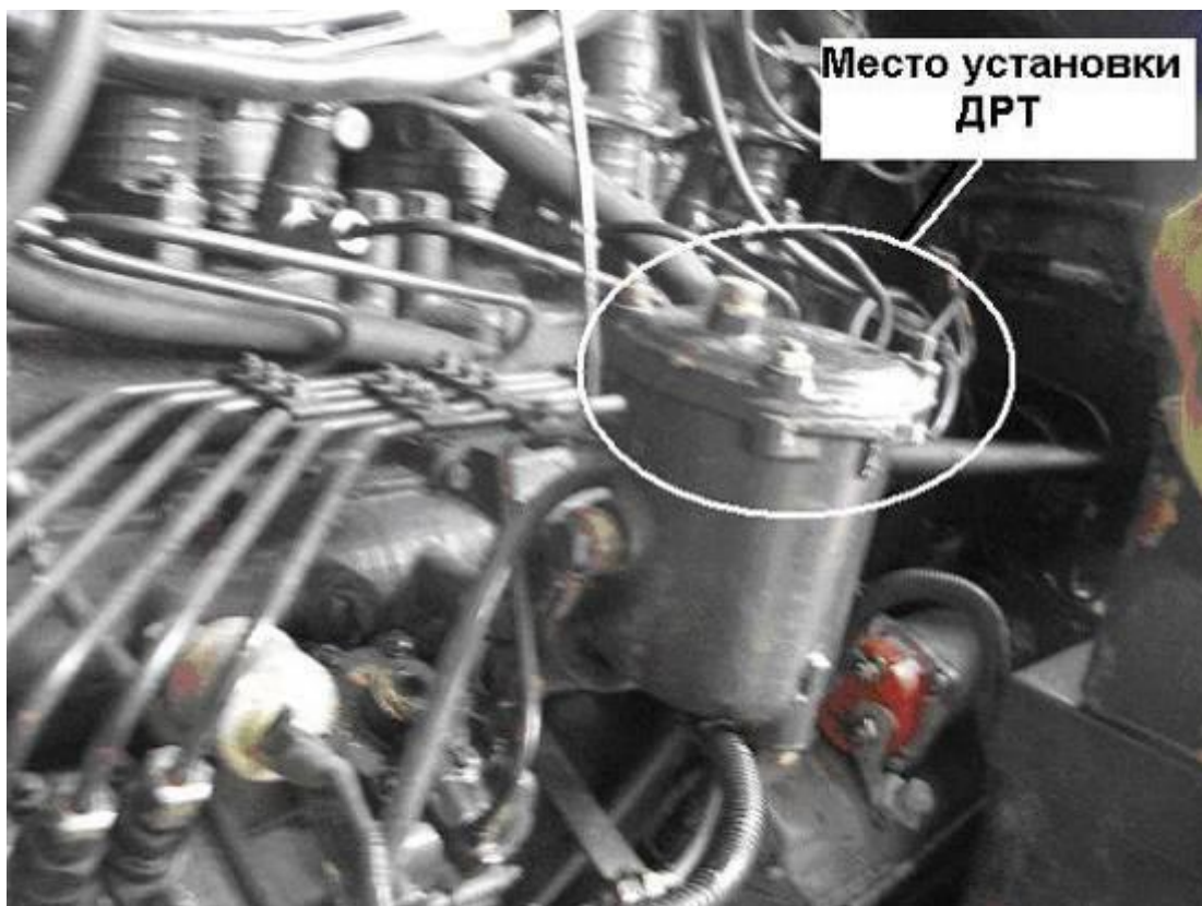
Рис. 5 Возможное место установки ДРТ
