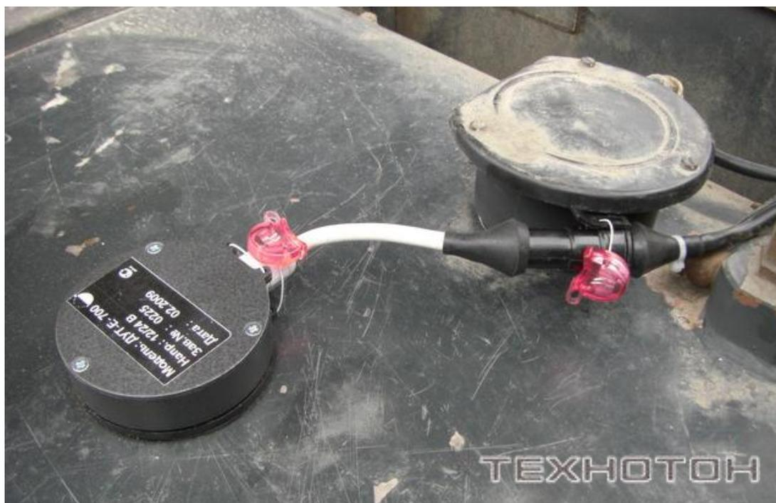
Пломбировка электрического соединения ДУТ-Е
