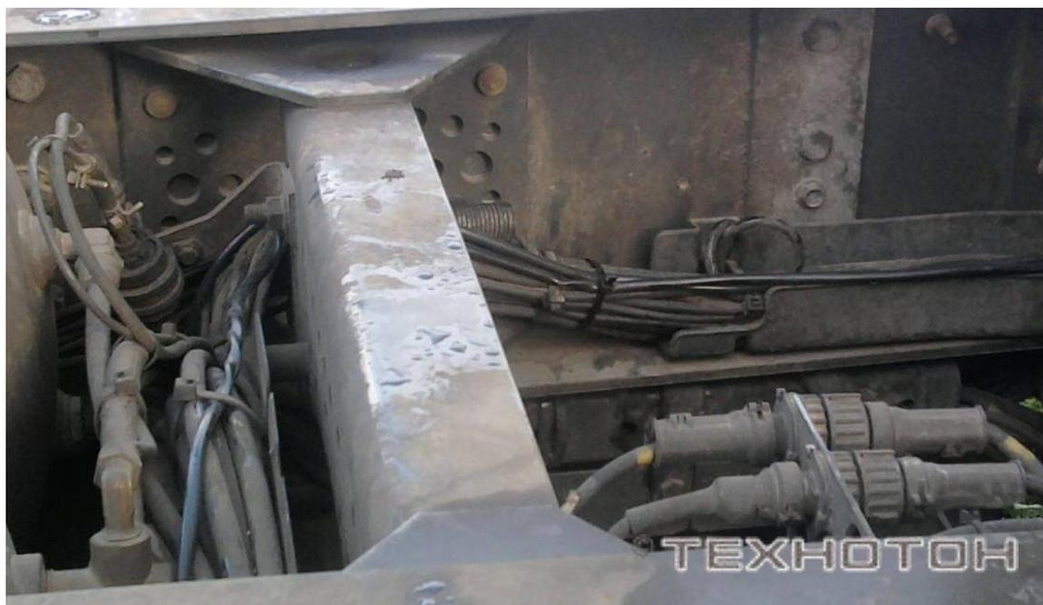
Рис. 6 Укладка сигнального жгута ДУТ-Е
