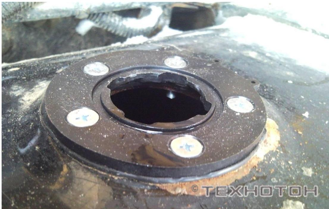
Установка переходной пластины в штатное отверстие
