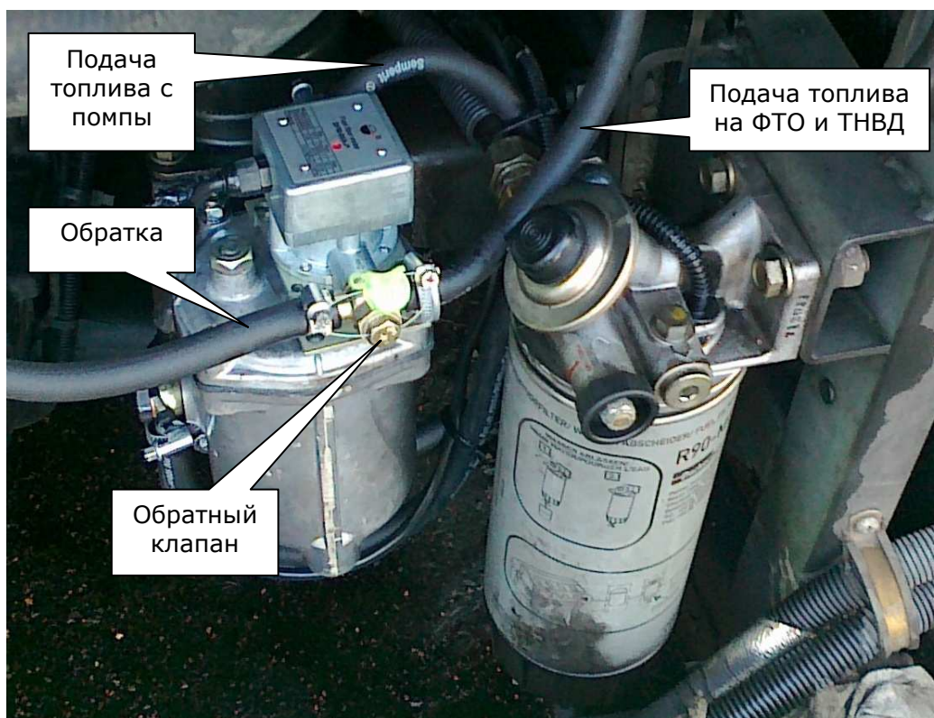
Рис. 9 Схема установки DFM на разрезание без деаэратора на двигателе Mercedes
