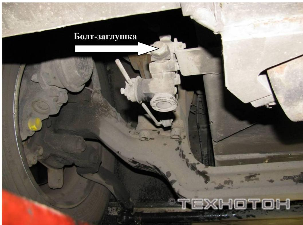
Рис. 2 Установка ДДЭ-8 в штатное отверстие воздушной магистрали подушки пневмоподвески
